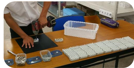
電動ドライバーでの解体作業
